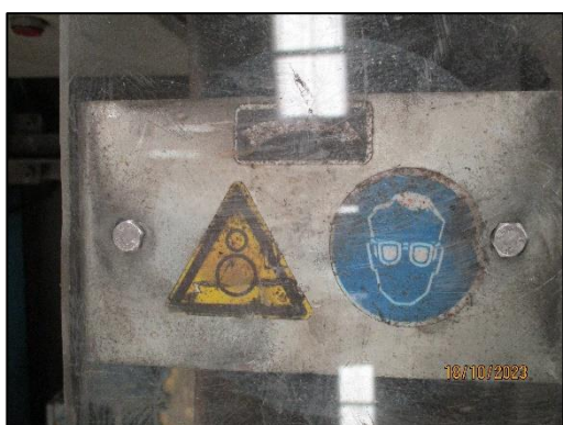
รูปที่ 3-37 การ์ดป้องกันวัสดุกระเด็นเข้าตาที่เครื่องจักร
